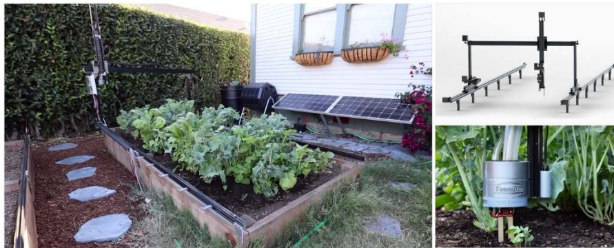
Figure 3. FarmBot utilise un contrôle numérique pour placer des outils (semoir, arrosoir, pince de désherbage, capteur d'humidité du sol) dans un espace de travail fixe. Source : https://genesis.farm.bot/docs
