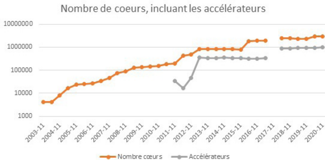
Figure 2 : Évolution du nombre de cœurs de calcul, incluant les accélérateurs, pour la moyenne des dix superordinateurs les plus puissants
