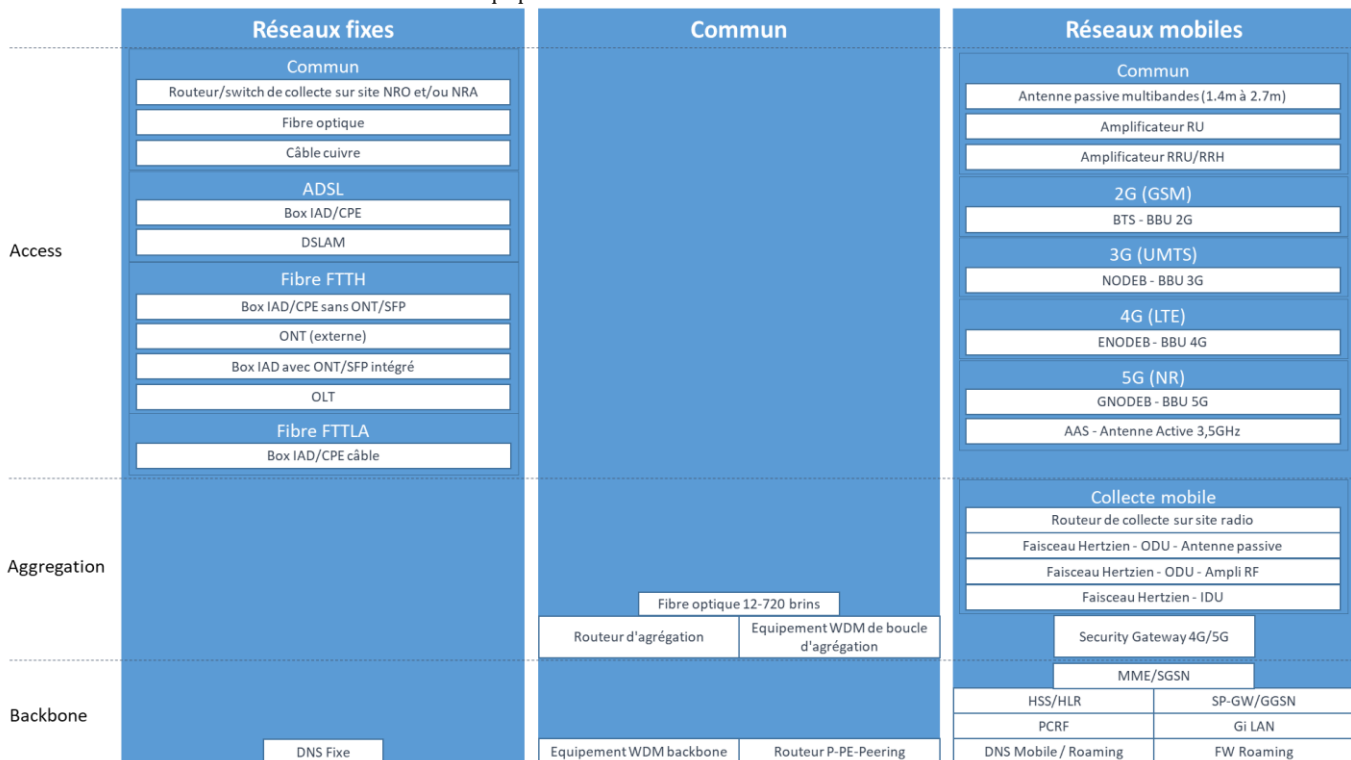
Figure 8 - Equipements constitutifs des réseaux
