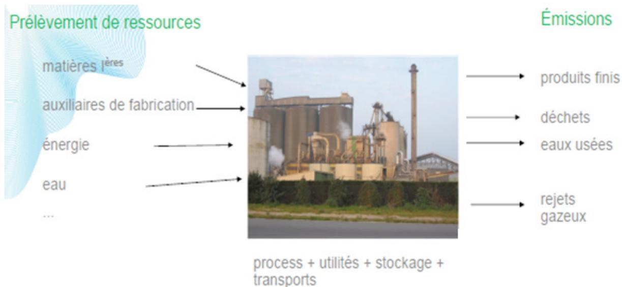
Figure 13 - Flux de matières dans une usine de fabrication d'aliments (F. Bosque, ITERG)
