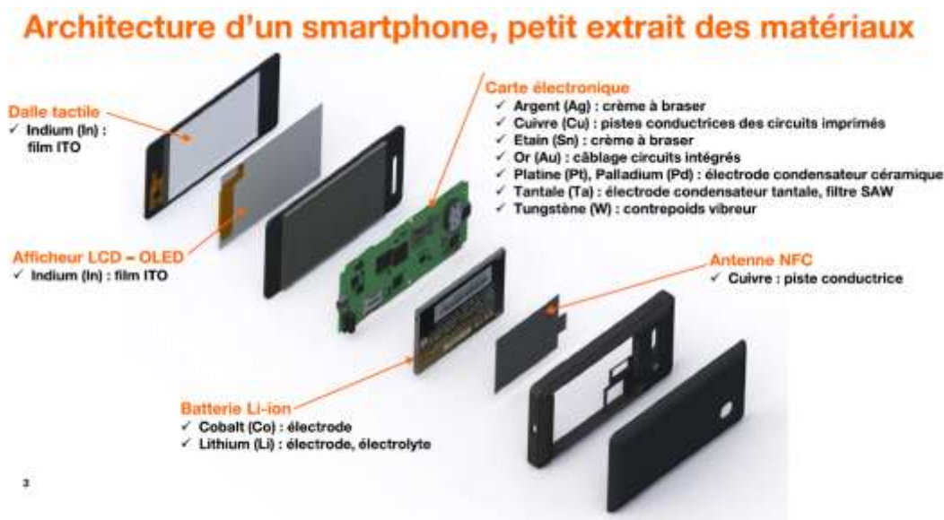
Figure 10 : Architecture d'un smartphone, petit extrait des métaux [Source : (Orange Labs, 2017)]
